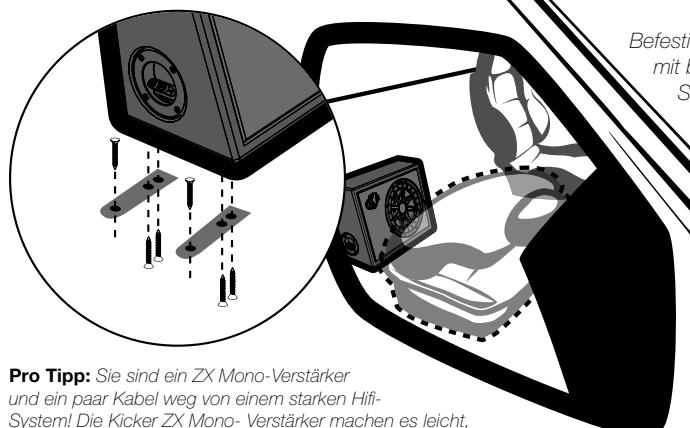
Befestigen Sie die Halterungen mit beiliegenden kleineren Schrauben an beiden Seiten des Gehäuses. Befestigen Sie dann das Gehäuse zum Fahrzeug mit den beiliegenden größeren Schrauben.
